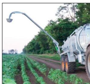
Rotación y levantamiento por cilindros hidráulicos.
