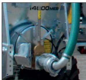
Conexión sobre la compuerta y enganche rápido del esparcidor.
